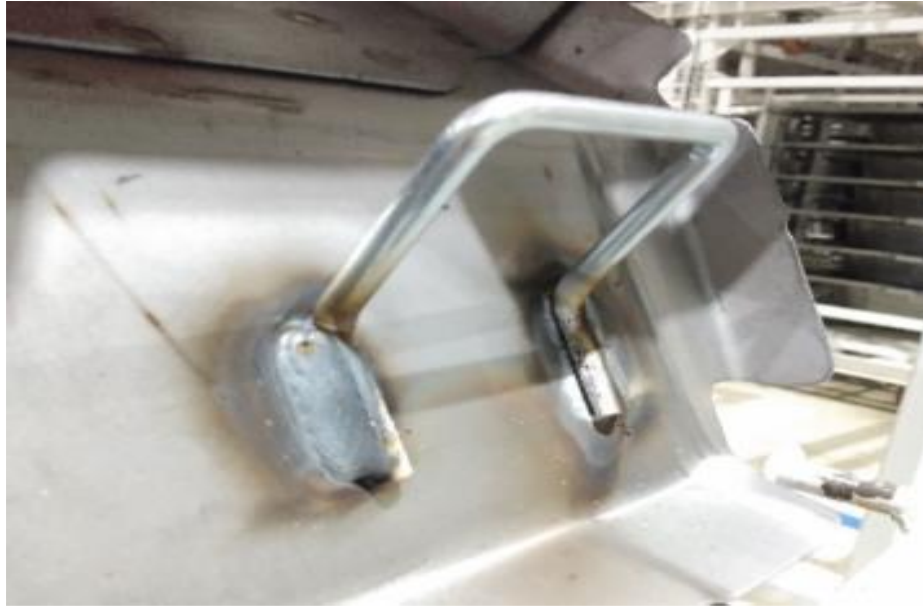
Fig. 6 : MIG Weld Before
